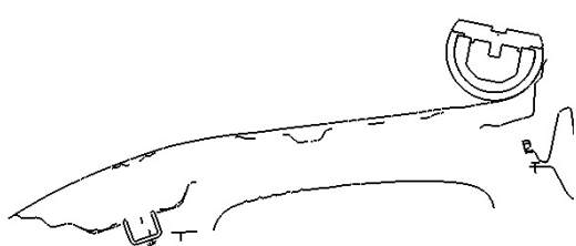
图 16 机盖后边缘撞击区域-20ms
