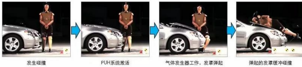
图 2 主动机罩-行人保护作用原理
