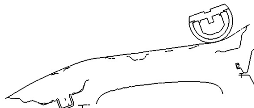
图 14 机盖后边缘撞击区域-8ms
