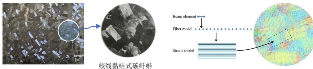
图 9 长玻璃纤维和绞线黏结式碳纤维的梁单元模型[6]
