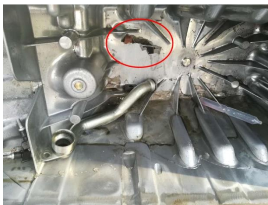
图 1 油底壳破损情况
