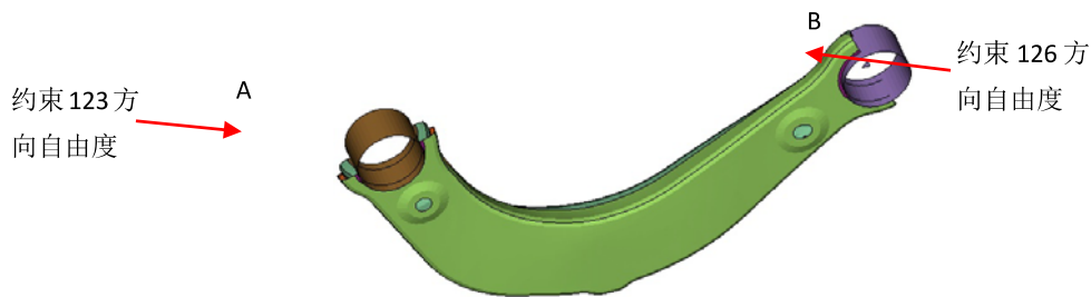
图 5 有限元模型的边界约束示意图
